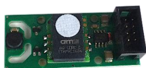
Sensorplatine im Gerät eingebaut
