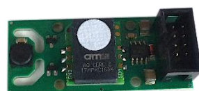
Sensorplatine im Gerät eingebaut
